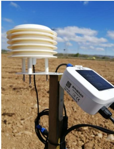
Equipo Atlas con sensores Temp. y humedad
